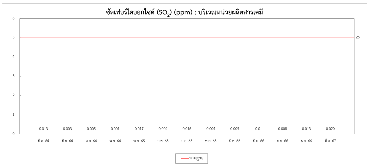
รูปที่ 3-35 การเปรียบเทียบผลการติดตามตรวจสอบสารเคมีในพื้นที่ทำงาน บริเวณหน่วยผลิตสารเคมี ระหว่างปี พ.ศ. 2564 - 2567
