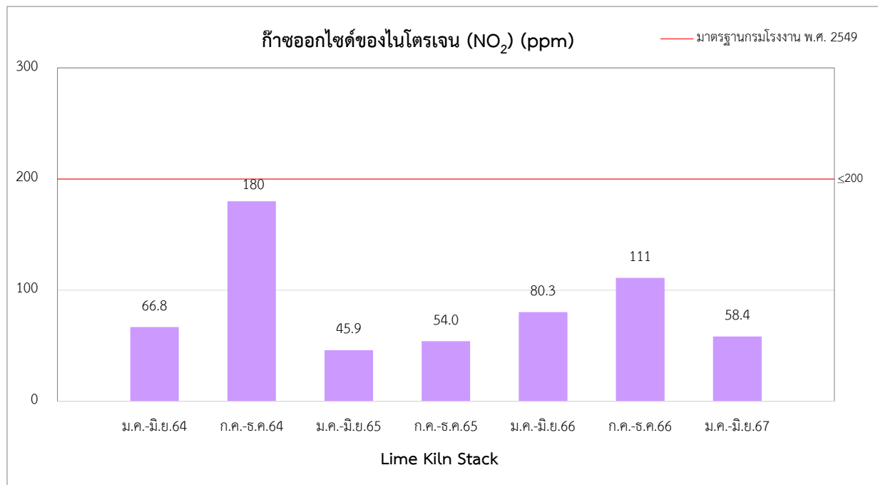
รูปที่ 3-9 กราฟแสดงการเปรียบเทียบผลการติดตามตรวจสอบคุณภาพอากาศเสียจากปล่อง Lime Kiln Stack ระหว่างปี พ.ศ. 2564 - 2567
